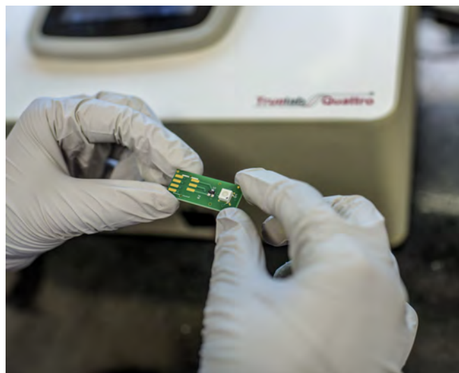
Un technicien de laboratoire prépare une puce avec un échantillon pour le diagnostic du COVID-19 au moyen d'un outil de diagnostic de pointe, qui permet un dépistage bidirectionnel, à la fois pour le COVID-19 et la tuberculose. Le Fonds mondial / Atul Loke / Panos
